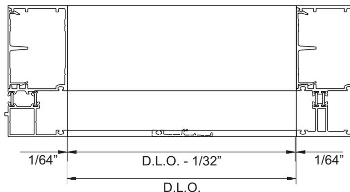
**FRAME FABRICATION****STEP 6****FABRICATE GLAZING ADAPTORS**
